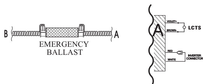
2.A) FLEX Conduit Wiring Diagram:
